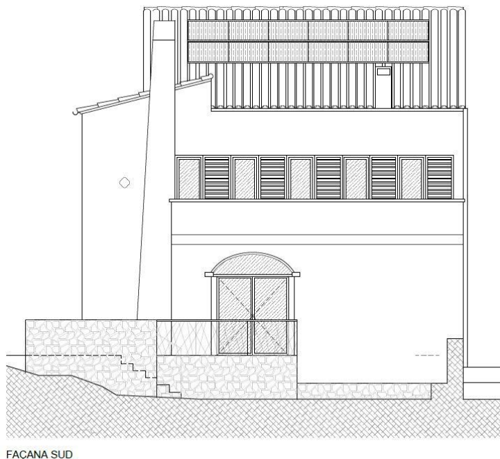
Figura 15. Instal·lació fotovoltaica a la coberta sud.
