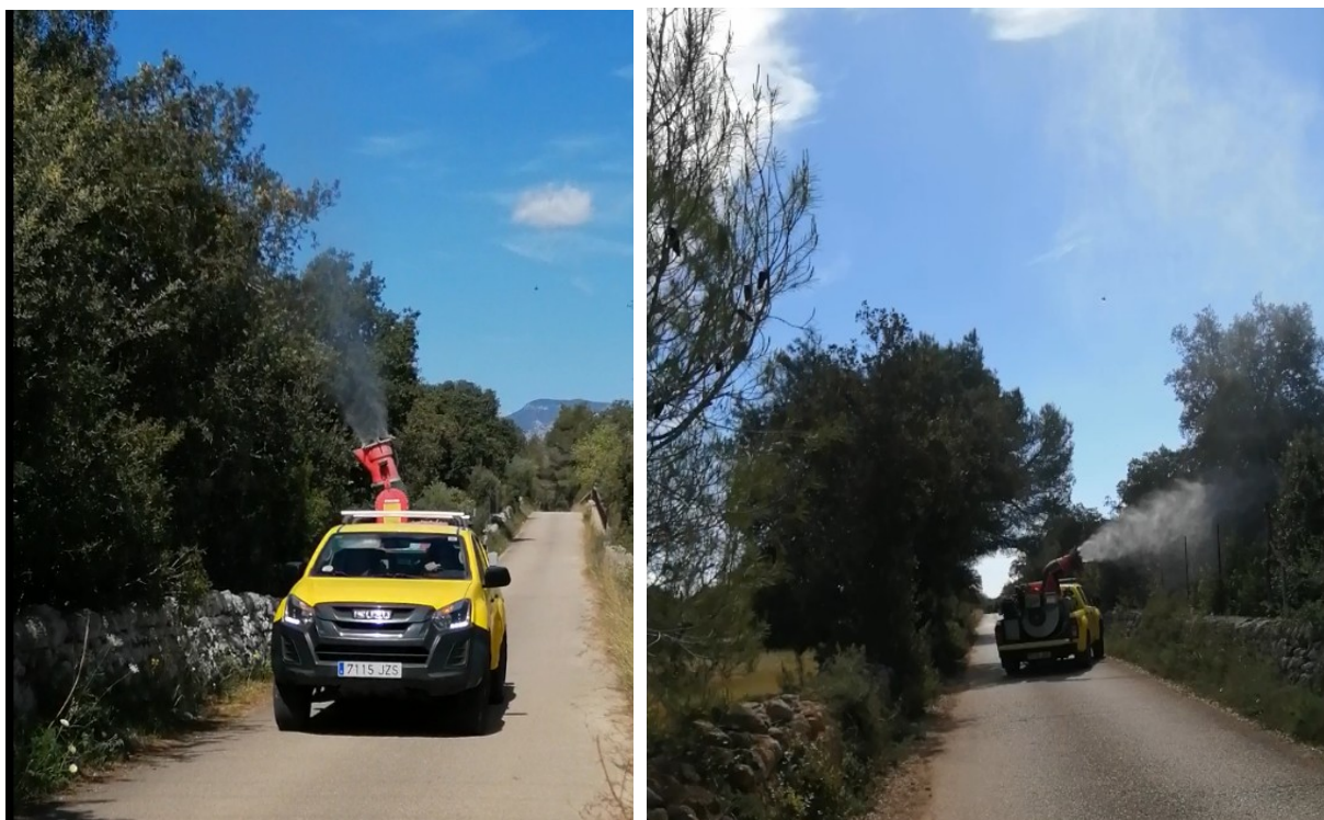
Fig 1: Tratamiento terrestre con cañón nebulizador y producto fitosanitario contra Lymantria dispar. IBANAT mayo 2024.
