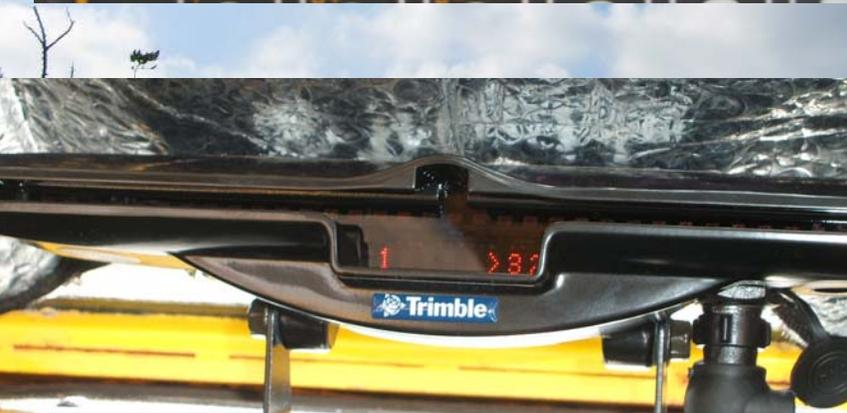
Barra de luces: marca la desviación de las continuas líneas de pulverización en grado sexagesimales y mediante la posición y el color de los LED
