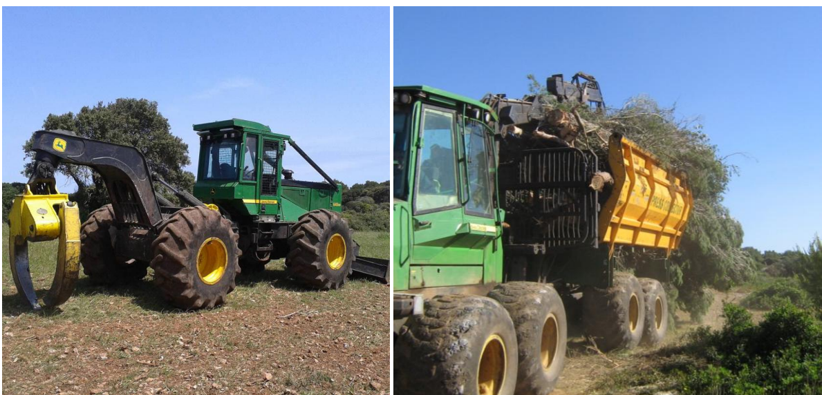
Foto 7: Skidder forestal per a desembosc amb pinça per a càrrega semisuspesa.
