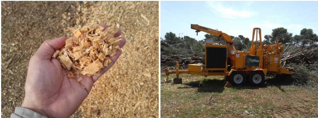
Foto 6: Detall de l'estella obtinguda i estelladora de discs utilitzada
