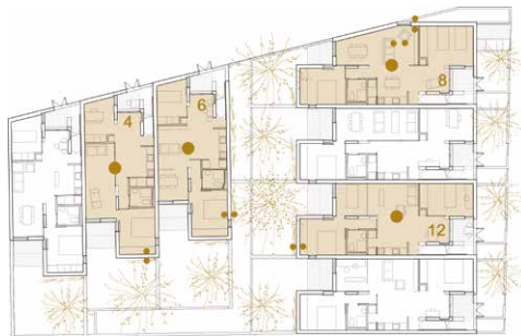
Ubicación sensores planta 1 First floor sensors location
