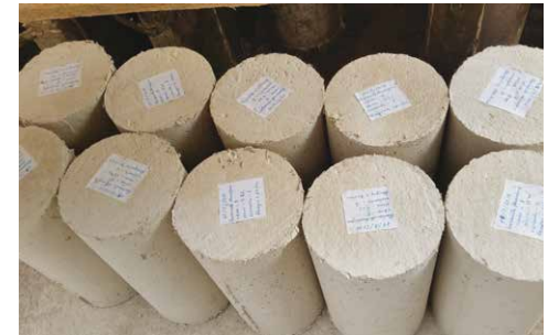
Probetas de hormigón de cal Lime concrete specimens
