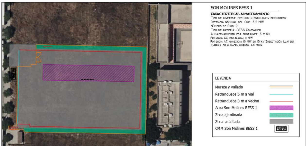
Imagen 3. Separación a deslindes final
