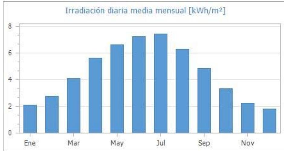
Fig. 1: Irradiación anual media mensual sobre el plano horizontal [kWh/m²] - Fuente datos: Meteonorm 7.1
