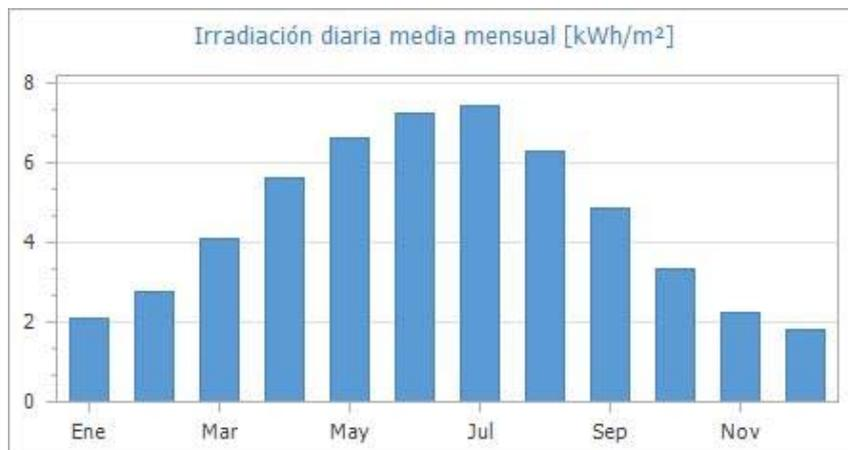
Fig. 1: Irradiación anual media mensual sobre el plano horizontal [kWh/m<sup>2</sup>] - Fuente datos: Meteonorm 7.1
