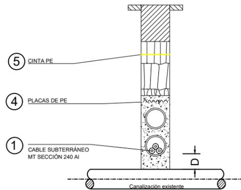
D: Distancia entre cables e instalación
