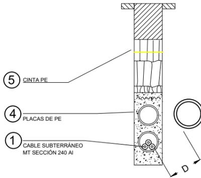
D: Distancia entre cables e instalación
