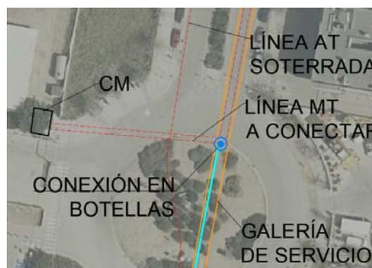
*Detalle Punto de Conexión. Conexión en botellas.*
