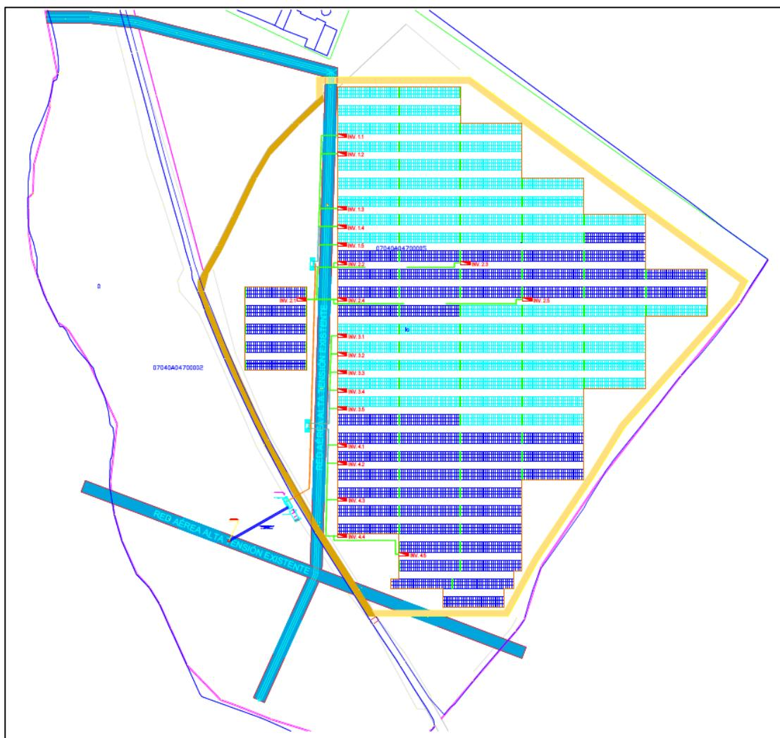
Figura 7 Implantación del parque fotovoltaico en la parcela.
