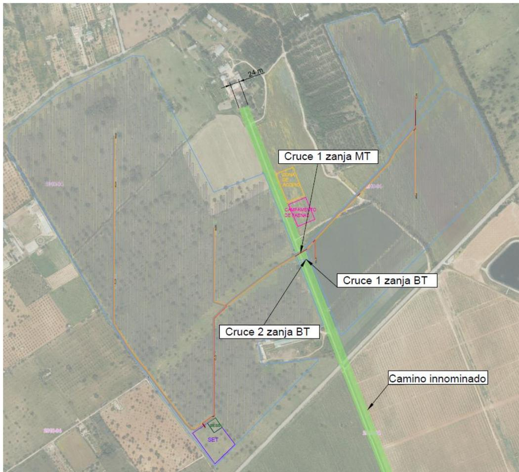
Figura 4: Cruzamiento con zanjas MT y BT
