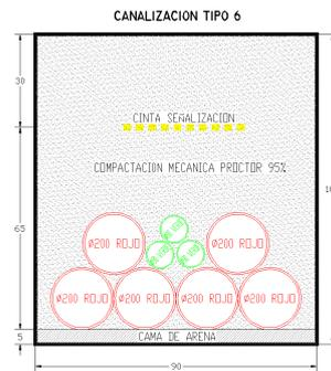
o Canalización eléctrica de alta tensión, (Se detalla en capítulo específico de A.T en Proyecto)
