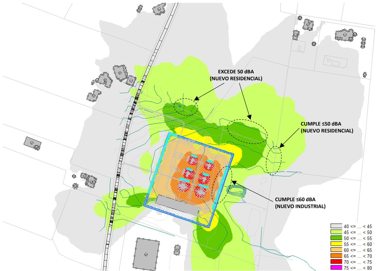
Figura 17. Nivel de ruido (dBA) generado por la subestación eléctrica, con apantallamiento acústico por las caras oeste y este de la parcela
