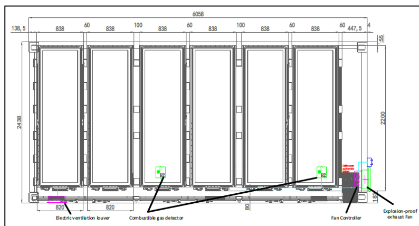
Imagen 28: Sistema de ventilación incorporado.
