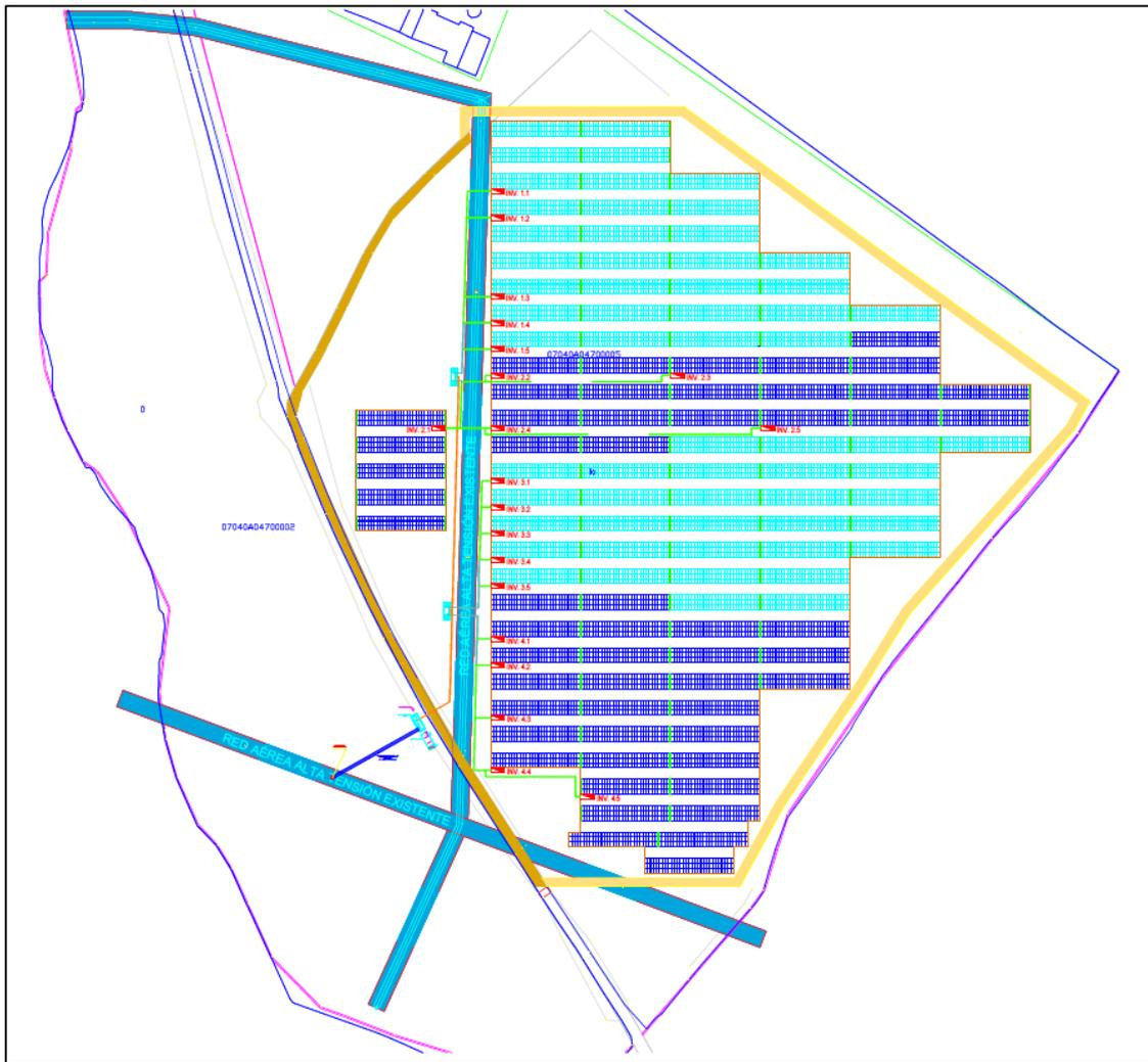
Figura 7 Implantación del parque fotovoltaico en la parcela.
