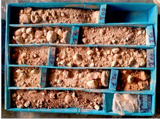
Fotografía 3: Caja de testigos del sondeo 3
