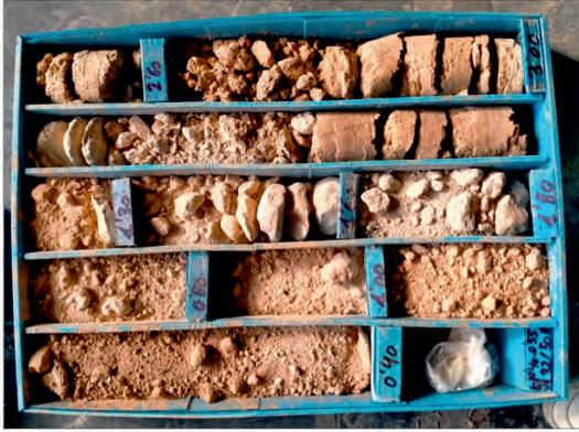
Fotografía 2: Caja de testigos del sondeo 2
