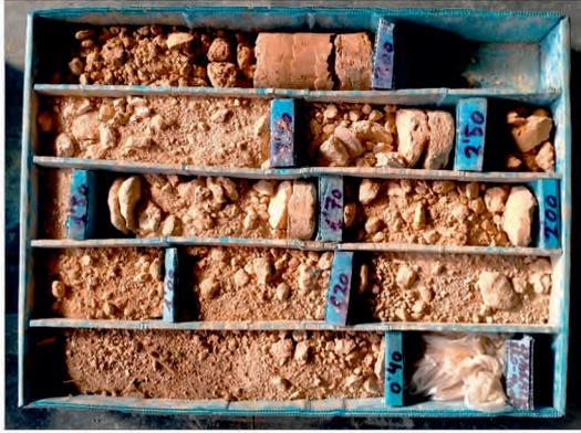
Fotografía 4: Caja de testigos del sondeo 4
