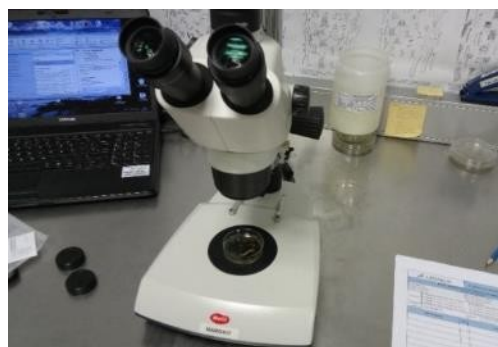
Fotografía 4: Tamiz y estereomicroscopio utilizado en la separación e identificación de los invertebrados.
