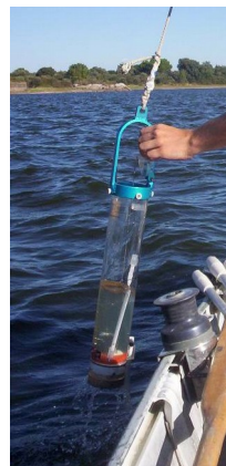
Fotografías 3 y 4: Sonda HYDROLAB (izquierda) y botella hidrográfica (derecha).
