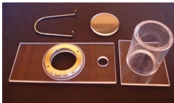
FOTOGRAFIA 5: Cambra i columna de sedimentació.
