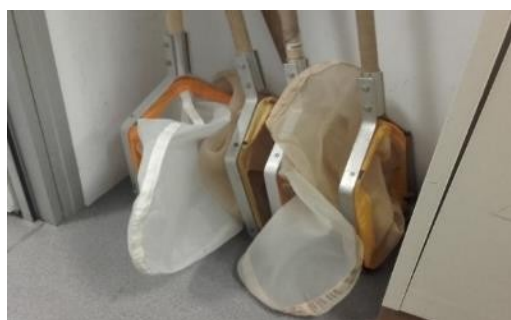
FOTOGRAFIA 3: Xarxes de mostreig de macroinvertebrats bentònics
