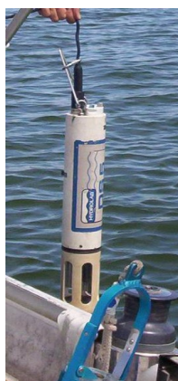
FOTOGRAFIES 3 I 4: Sonda HYDROLAB (esquerra) i ampolla hidrogràfica (dreta)
