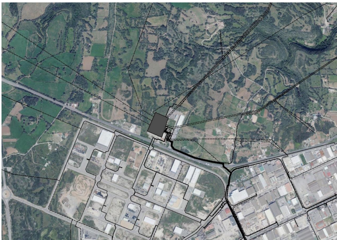
Figura 1. Ejemplo de sistema radial de la red de distribución eléctrica.
