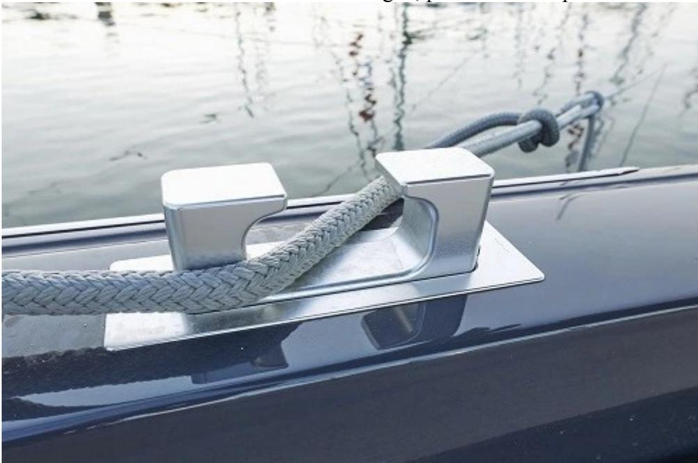
A: Es un guia-cabos, sirve para pasar y guiar cabos de amarre desde la embarcación hasta elementos de amarre externos.
