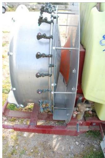
*Figuras 22 y 23 – Tractor con pulverizador hidroneumático y detalle de las boquillas antideriva.*
