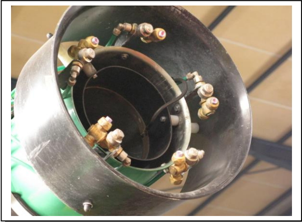
23.1 Broquetes del canó nebulitzador
