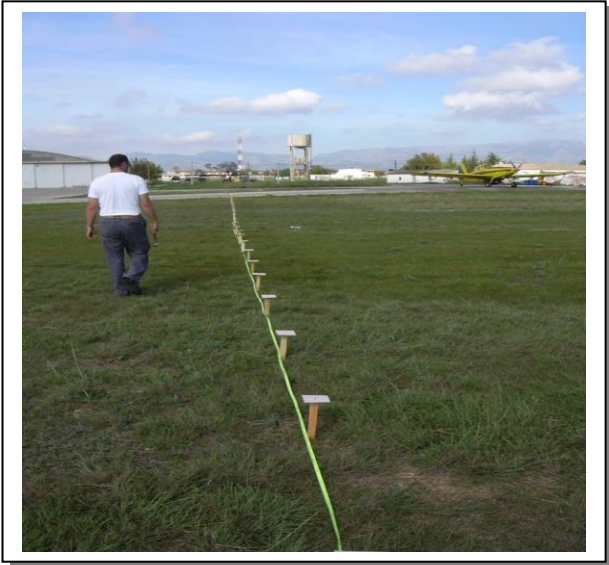
20.5 Colocación cada 2 m de controles
