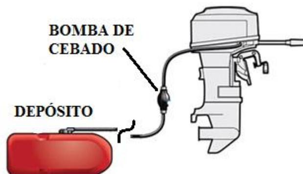
Figura 1.27. Sistema de alimentación de gasolina de un motor fueraborda.
