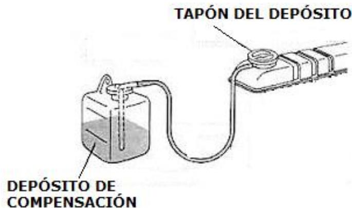
**Figura 1.35. Tanque de compensación de refrigerante.**
