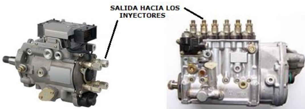
**Figura 1.26. Bomba rotativa (izquierda) y bomba en línea (derecha).**
