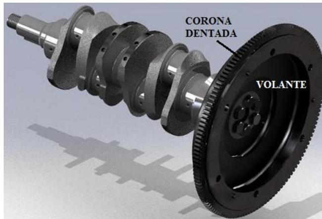
**Figura 1.8. Volante de inercia.**
