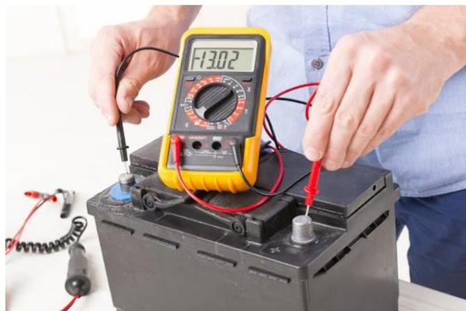
**Figura 3.15. Comprobación de la carga de una batería mediante un voltímetro.**
