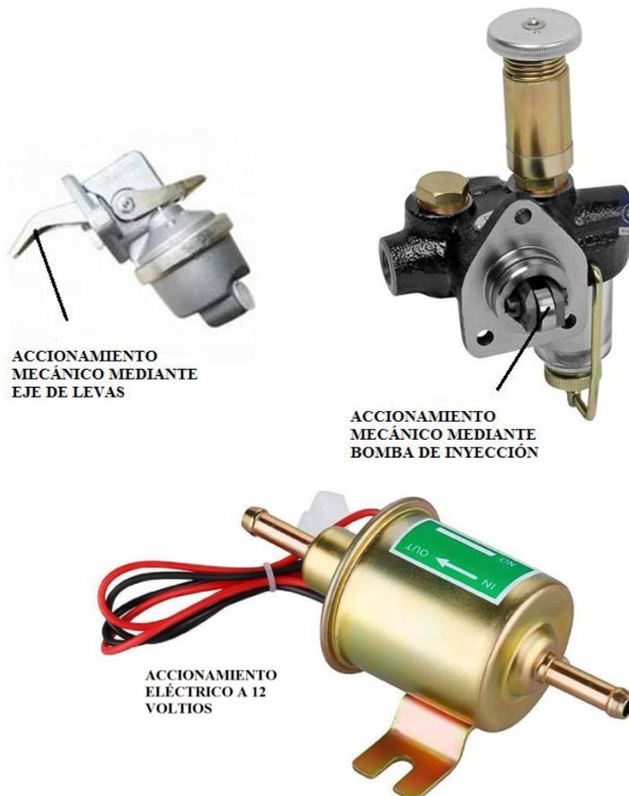
Figura 1.24. Diferentes bombas de alimentación mecánicas y eléctrica.
