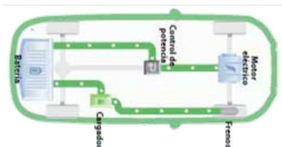
Fig. 38. Vehículo totalmente eléctrico. Fuente: MELIB
