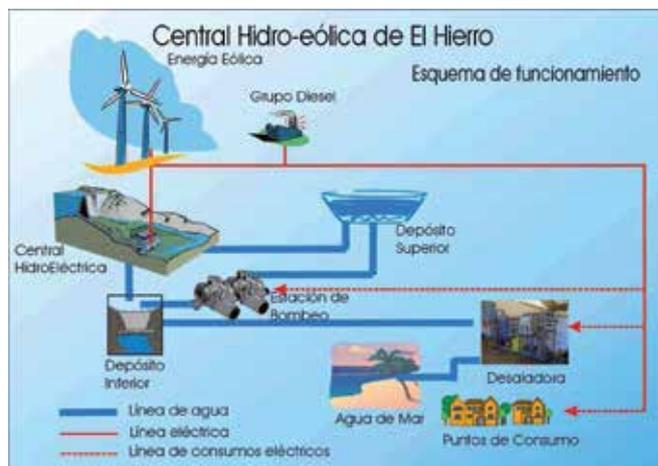
Fig. 32 Esquema de la Central Hidroelétrica Garona del Viento, el Hierro
