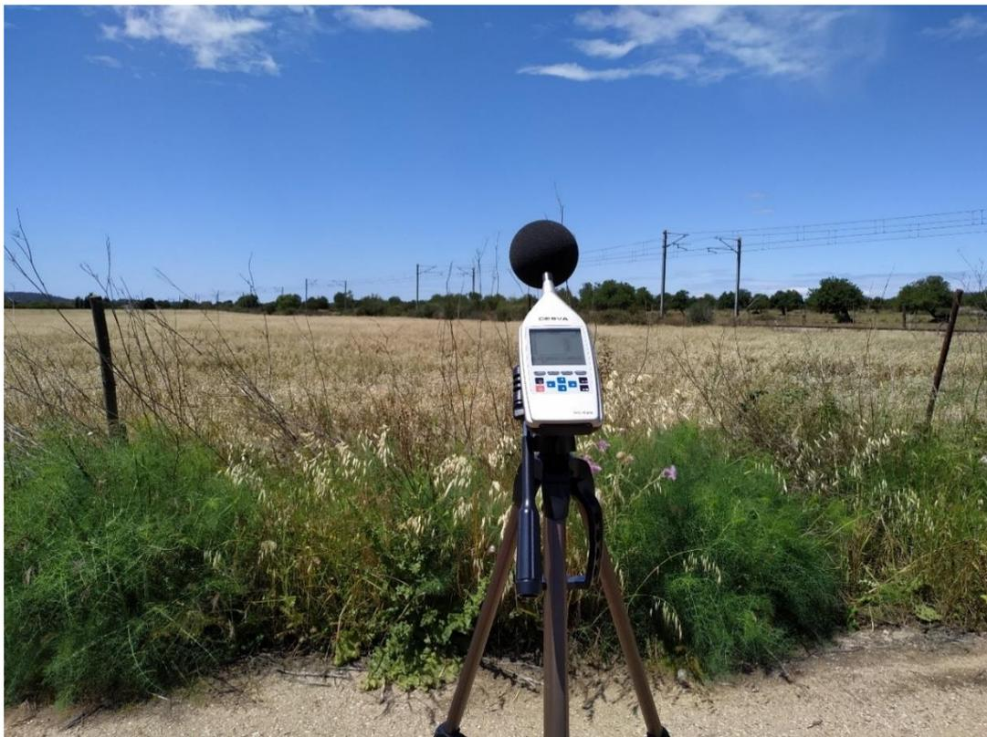
*Detalle del muestreo acústico realizado en el punto 9. Fuente: PODARCIS, S.L.*
