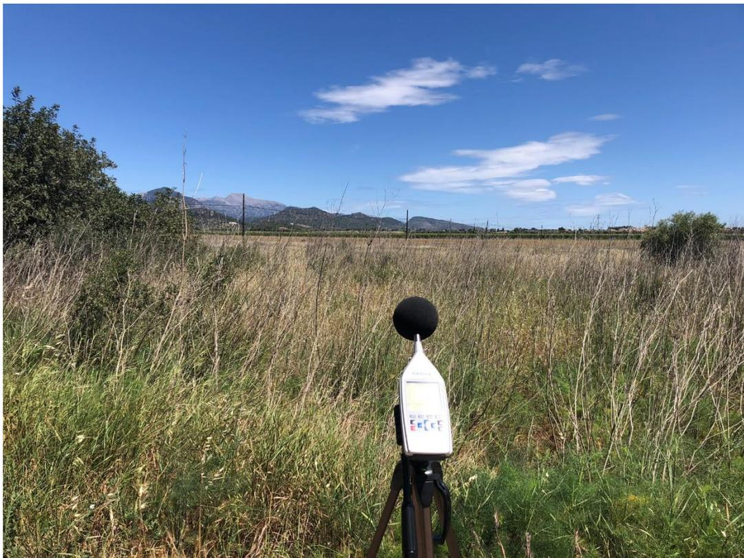
*Detalle del muestreo acústico realizado en el punto 11. Fuente: PODARCIS, S.L.*
