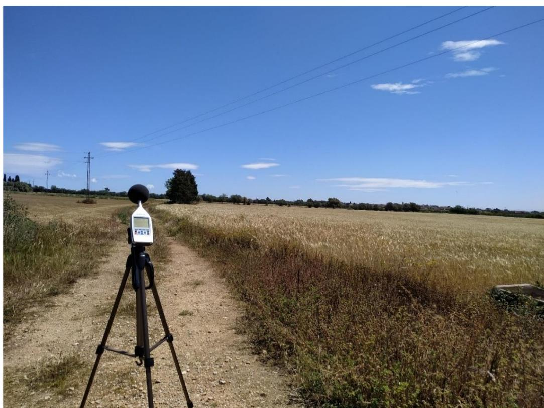
*Detalle del muestreo acústico realizado en el punto 7. Fuente: PODARCIS, S.L.*
