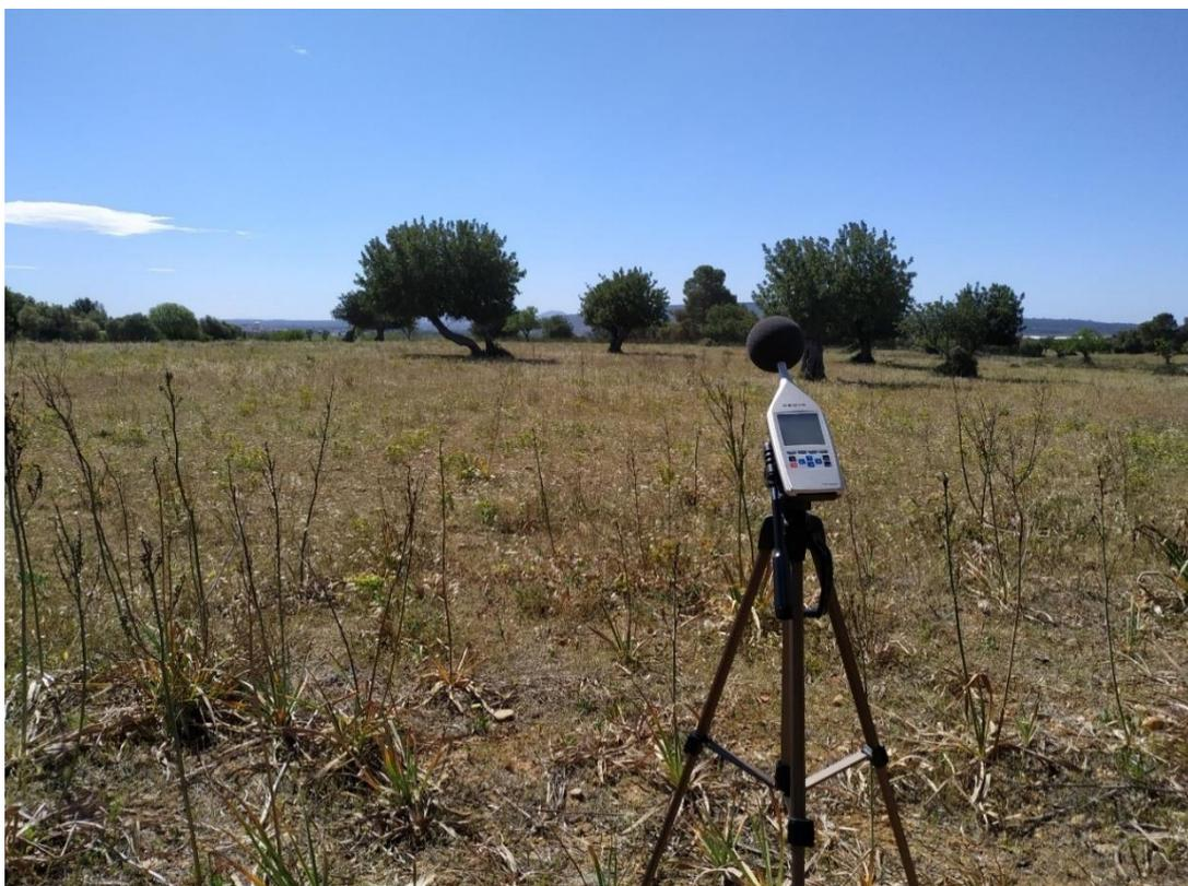
*Detalle del muestreo acústico realizado en el punto 3. Fuente: PODARCIS, S.L.*
