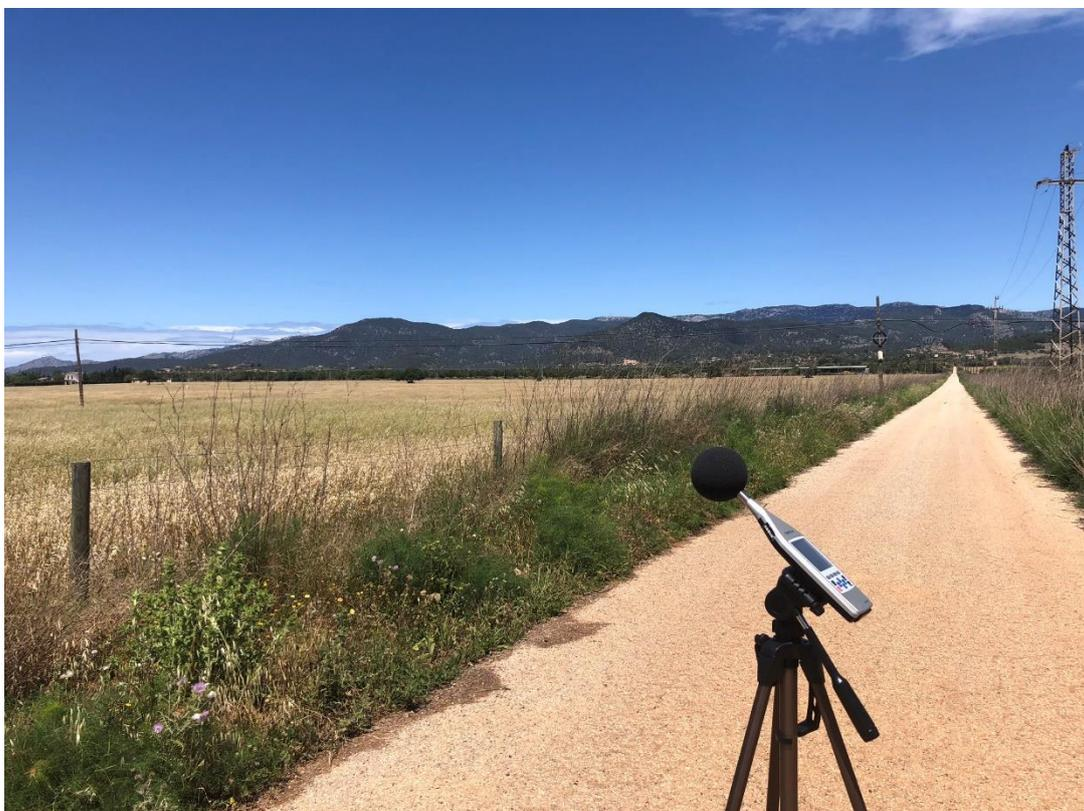
*Detalle del muestreo acústico realizado en el punto 10. Fuente: PODARCIS, S.L.*
