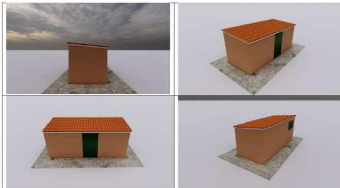
**Ilustración 10.- Detalle del CMM FV con acabado exterior tipo “embetumat” color ocre tierra y cubierta inclinada con teja árabe a un agua.**
