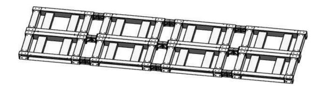
Hasta 8 unidades del "Blue LMP 400" se ensamblan en un SKID, junto con el cuadro de potencia:
