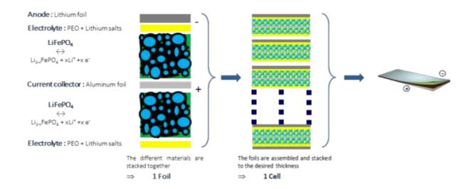
El voltaje de la celda es de 3,42 V y debido a su estado completamente sólido, la densidad de la celda es mayor que la mayoría de las otras tecnologías:
