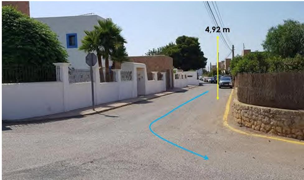
Ilustración 6- Gálibo vertical en la calle de Picas Soques en el PK 0+029.
