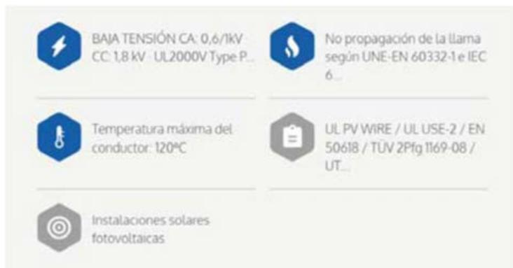
Los cables de la instalación serán de cobre, con una sección suficiente para asegurar pérdidas por efecto joule inferiores a 1,5% de la tensión nominal tal y como pide el pliego de condiciones técnicas del IDAE y el reglamento electrotécnico para baja tensión.
