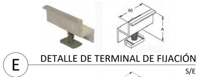
**E** DETALLE DE TERMINAL DE FIJACIÓN
