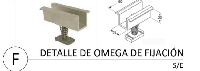
**F** DETALLE DE OMEGA DE FIJACIÓN
