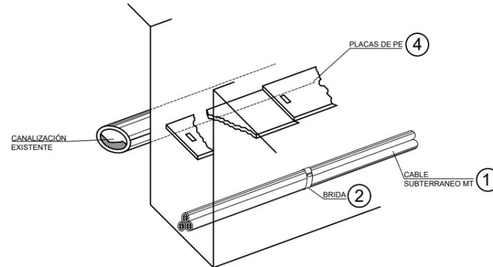
Cuando no pueda respetarse alguna de estas distancias, el cable que se tienda en último lugar se dispondrá separado mediante tubos, conductos o divisorias constituidos por materiales incombustibles de adecuada resistencia mecánica.
