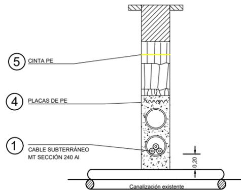
Distancia entre cables y canalización  $\geq 0,2$  m
