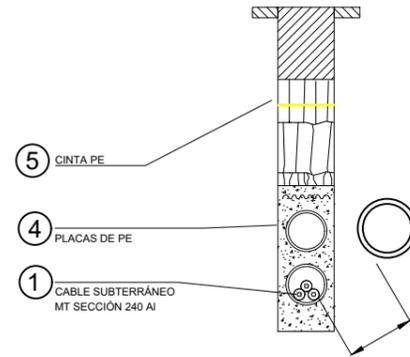
Distancia entre cables y canalización  $\geq 0,2$  m
