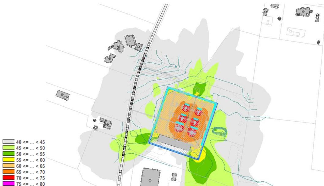
*Nivel de ruido (dBA) generado por la subestación eléctrica, con apantallamiento acústico*
