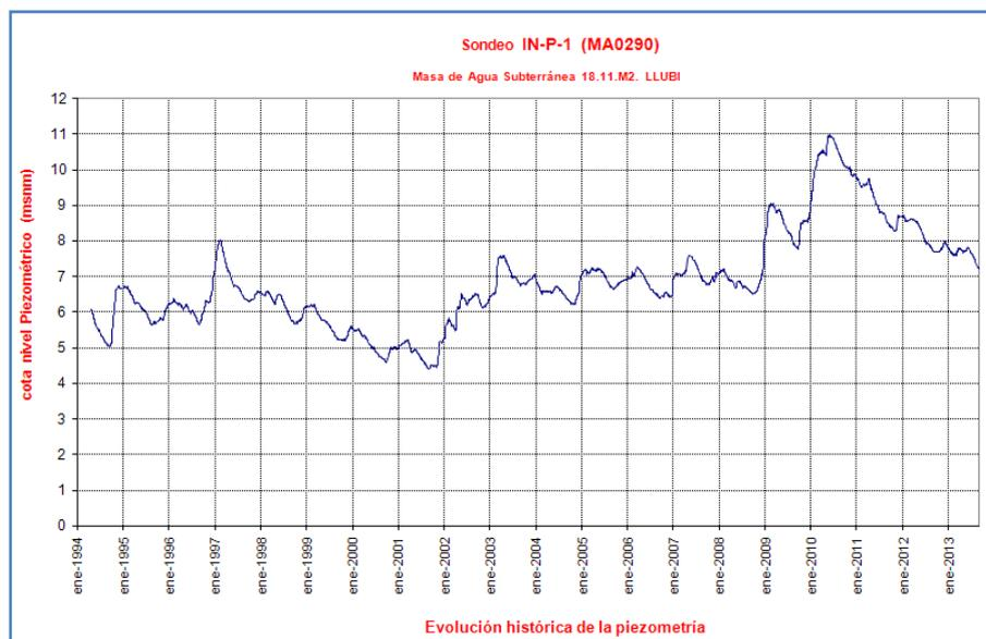
Figura 53: Gráfico de evolución del nivel piezométrico medido con limnógrafo en uno de los piezómetros de control.
