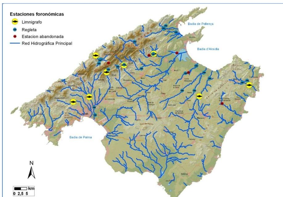
Figura 44: Situación de las estaciones de aforo de la demarcación.
