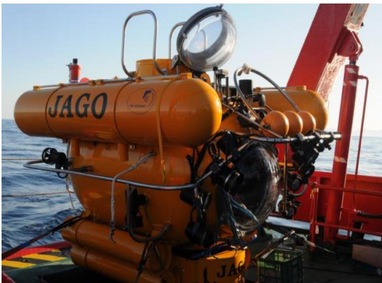
**Figura 5.2.-** Submarino tripulado JAGO IFG-Geomar. Capacidad para 2 personas, piloto y científico. Además se dispone de un brazo articulado para la recogida de muestras.
