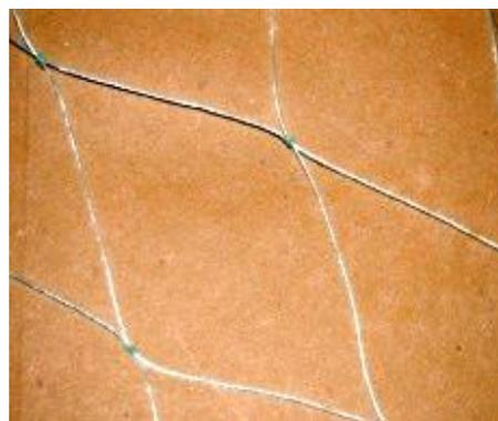
Figura 2.10.- Imágenes en detalle de los dos tipos de material empleados en el paño interior de los trasmallos experimentales. El material PMF (Poliamida Multi Filamento) es el que se utiliza tradicionalmente, y el material MMF (Multi Mono Filamento) es el nuevo material objeto de estudio.
