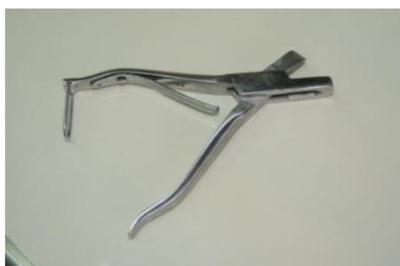
**Figura 1.4.-** Herramienta muescadora utilizada para hacer las marcas en "V".
