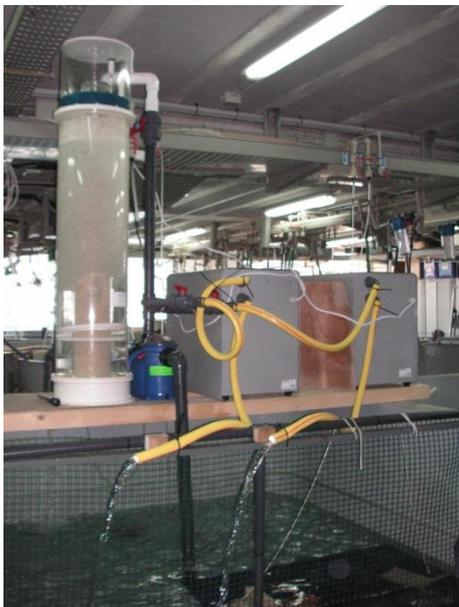
**Figura 1.2.-** Instalación del sistema de bombeo, enfriadores y filtro biológico en el LIMIA.
