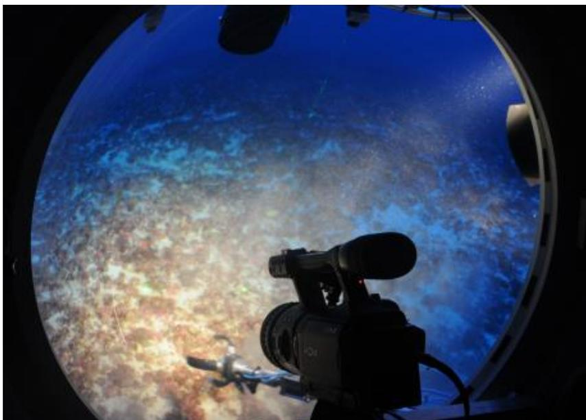
**Figura 5.3.-** Imagen desde el interior del submarino JAGO en la que se aprecia la cámara de video y el brazo articulado para recoger muestras.
