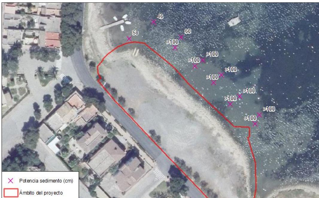
Figura 36. Potencia del sedimento en el entorno de la explanada. (Fuente: elaboración propia)
